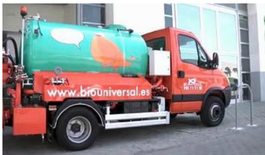
Figura 7-21 Tipuri de camioane și furgonete pentru transportul uleiurilor uzate din punctele de colectare
